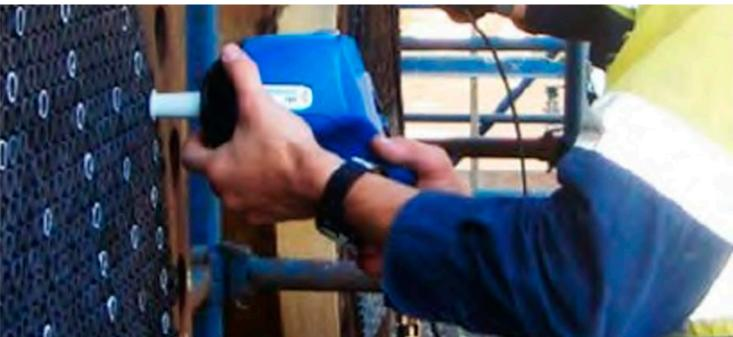
Acoustic-eye es una solución no invasiva para inspeccionar tubos hasta 4" de diámetro de forma rápida y precisa en calderas, intercambiadores de calor, independiente de la forma del tubo y tipo de material.
