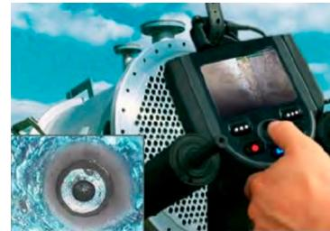
Con esta inspección podemos observar y determinar la presencia de obstrucciones, defectos superficiales internos, formaciones de cascarillas, óxidos y/o adherencias.
