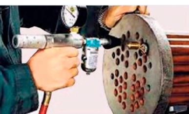
Los controles periódicos en los tubos de intercambiadores, enfriadores y condensadores son esenciales a fin de mantener el máximo rendimiento de estos equipos. En complemento a las técnicas de inspección en los
